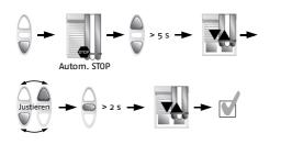
Drücken Sie AB, um die untere Endlage anzufahren. Warten Sie, bis der Antrieb selbstständig stoppt. Drücken Sie in dieser Position gleichzeitig AUF und AB, bis der Antrieb mit einer kurzen AUF-/AB-Bewegung bestätigt. Justieren Sie die Endlage mit AUF bzw. AB. Speichern Sie die nderungen durch Drücken von STOP, bis der Antrieb erneut mit einer kurzen AUF-/AB-Bewegung bestätigt.
