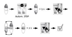
Drücken Sie AUF, um die obere Endlage anzufahren. Warten Sie, bis der Antrieb selbstständig stoppt. Drücken Sie in dieser Position gleichzeitig AUF und AB, bis der Antrieb mit einer kurzen AUF-/AB-Bewegung bestätigt. Justieren Sie die Endlage mit AUF bzw. AB. Speichern Sie die nderungen durch Drücken von STOP, bis der Antrieb erneut mit einer kurzen AUF-/AB-Bewegung bestätigt.
