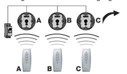
Antriebe A, B, C sind an einer Sicherung angeschlossen.
