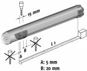
**Verschrauben** Sie nun die Welle/das Präzisionsrohr mit dem Mitnehmer an der vorher berechneten Stelle (siehe Grafik).
