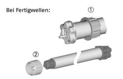
Auf den Antrieb den zur jeweiligen Antriebswelle passenden Adapter ① schieben. Achten Sie hierbei bitte auf den richtigen Sitz am Nocken. Anschließend den passenden Mitnehmer ② aufclipsen.
