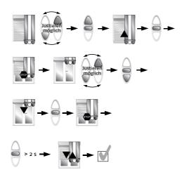
Fahren Sie den Behang in die gewünschte untere Endlage. Drücken Sie aus dieser Position gleichzeitig STOP und AUF. Der Behang fährt in AUF-Richtung. Sie können den Antrieb nun wieder stoppen. Fahren Sie den Behang nun in die gewünschte obere Endlage. Drücken Sie aus dieser Position gleichzeitig STOP und AB. Der Behang fährt in AB-Richtung. Sie können den Antrieb nun erneut stoppen.
